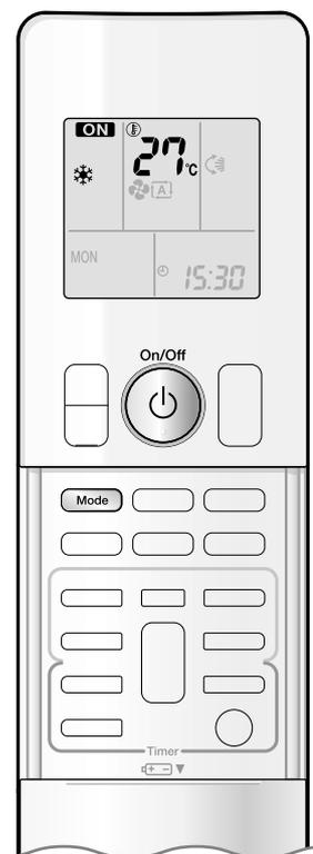
Il condizionatore d'aria funziona con il modo funzionamento di vostra scelta. A partire dalla prossima volta, il condizionatore d'aria entrerà in funzione con lo stesso modo di funzionamento.
